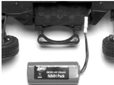
2. Inserire il caricabatterie a CA nella presa a parete appropriata (110 V - versione USA). Inserire il gruppo batteria nel caricabatterie e lasciarlo sotto carica per 1 ora la prima volta. Caricare ancora per 1 ora per ottenere una carica completa. Se la batteria viene caricata per oltre un'ora potrebbe verificarsi un sovraccarico.
