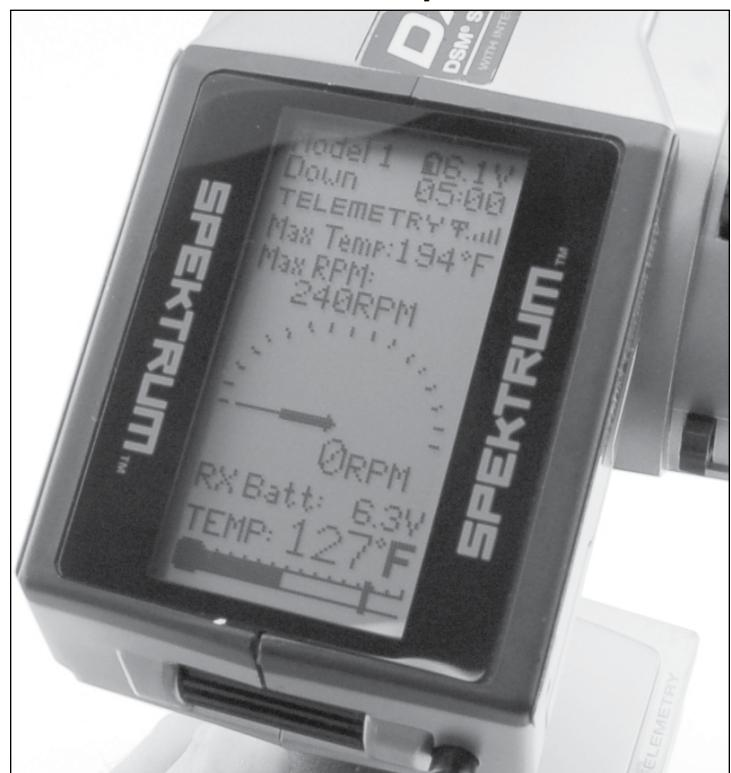
Die ideale Betriebstemperatur variiert mit der Lufttemperatur und Höhe. Generell sollte diese bei 88° bis 110° liegen. Die Motortemperatur wird Ihnen auf dem Senderdisplay angezeigt so lange der Sensor an dem Motor angebracht ist.
