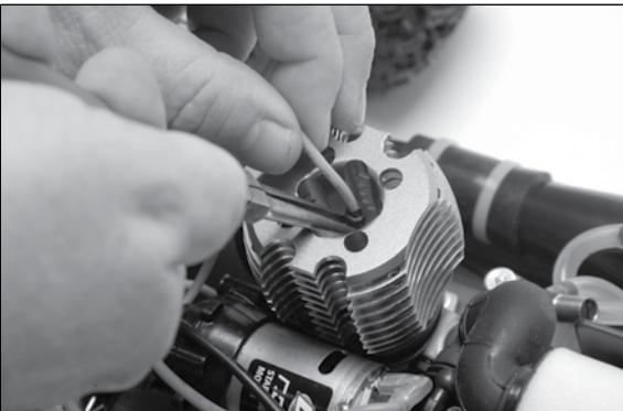
3. Trennen Sie das rote (+) Kabel vom Starter Motor.
